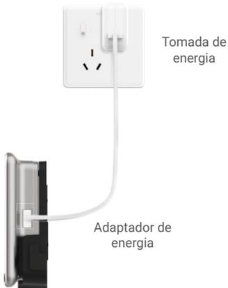
Conecte o painel à tomada com o adaptador de energia (5 V, 2 A, vendido separadamente).
