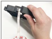
Retire a base, engate o conector na entrada na parte inferior da base e insira a tampa da base.
